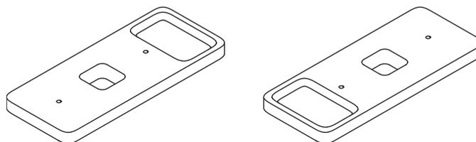
Je nach Einbauvariante ändert sich der Bezugspunkt des Ablaufs (und der Wandarmatur). Dieser ist der Ausgangspunkt zum Messen der Befestigungspunkte. In der Technischen Zeichnung sind die Maße angegeben wenn die Ablage rechts montiert wird.
