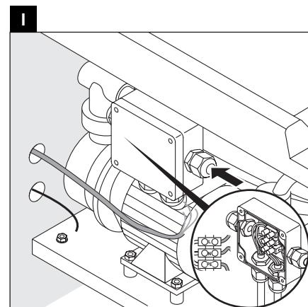
**II** Raccorder le câble pour la liaison équipotentielle à la baignoire balnéo.
