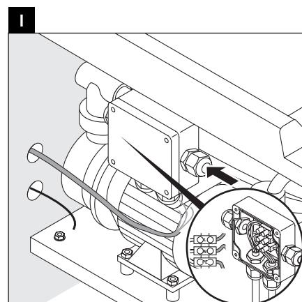
**II** K vířivé vaně připojte kabel pro vyrovnání napětí.
