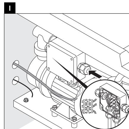
**II** Podłączyć przewód wyrównania potencjałów do wanny z hydromasażem.
